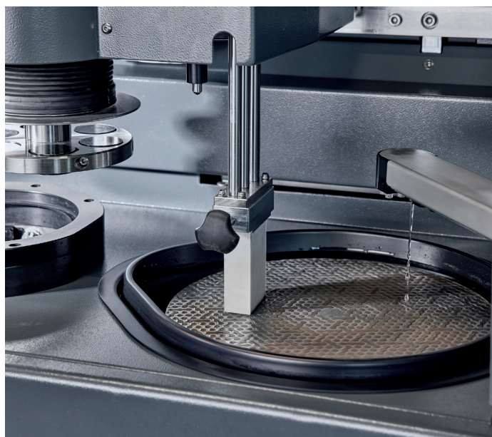
Afilado de MD-Piano con una varilla de óxido de aluminio.
